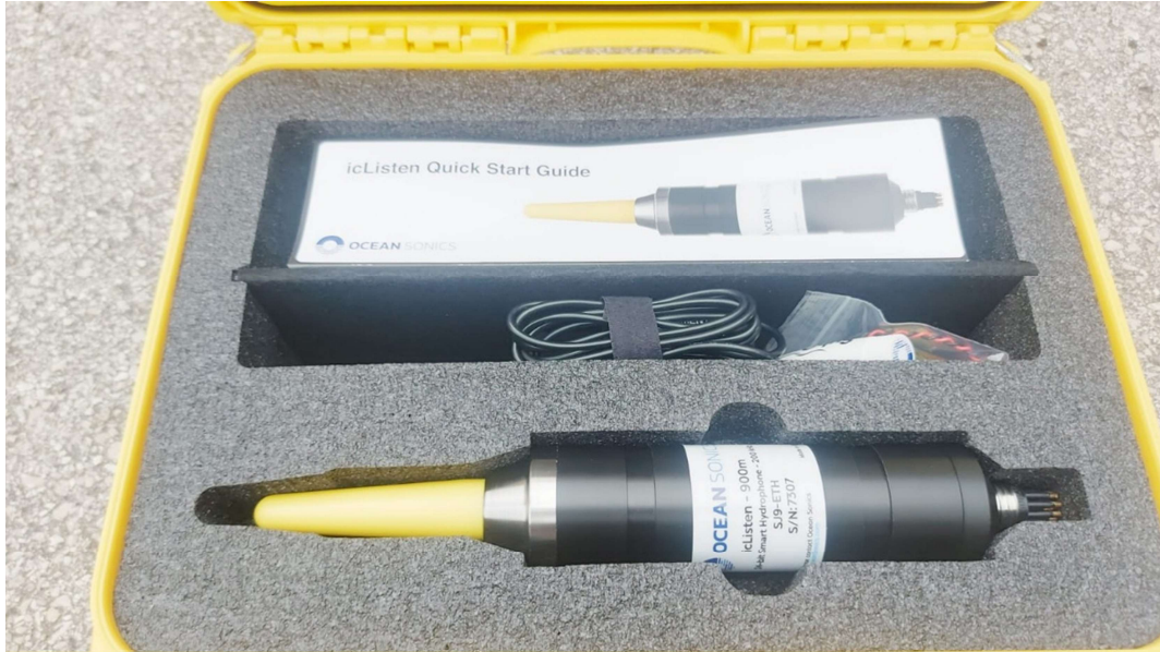
Figura 3.1: Idrofono impiegato presso il sito di Napoli
