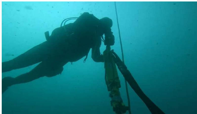
Figura 3.1: Sonda multiparametrica e sua installazione presso il sito di Napoli.
